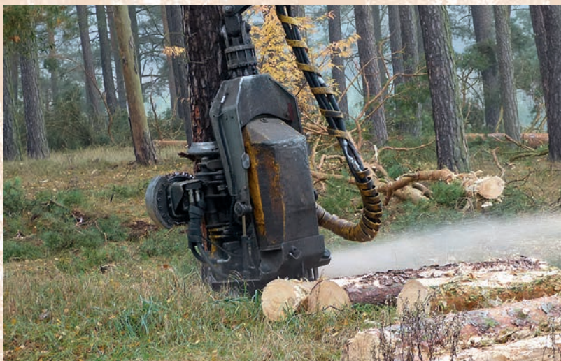
Z głowicy wysuwa się prowadnica z łańcuchem tnącym i ścina drzewo
