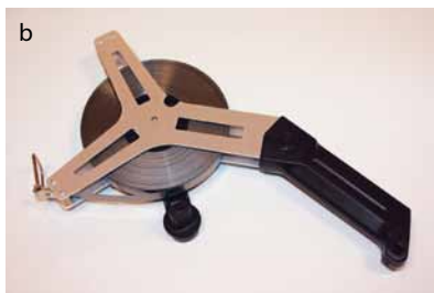
Elastyczne taśmy miernicze używane do pomiarów obwodów pni okazałych drzew: wykonana z tworzywa sztucznego (a); metalowa (b)
