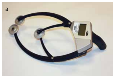
Nowoczesny średnicomierz elektroniczny zaprojektowany do pomiaru obwodów pni okazałych drzew (a) oraz sposób jego użycia (b)
