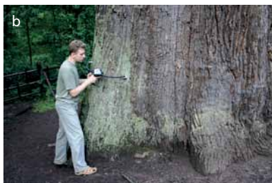
Nowoczesny średnicomierz elektroniczny zaprojektowany do pomiaru obwodów pni okazałych drzew (a) oraz sposób jego użycia (b)
