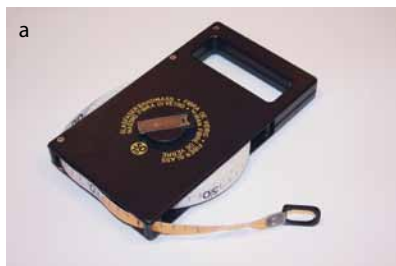
Elastyczne taśmy miernicze używane do pomiarów obwodów pni okazałych drzew: wykonana z tworzywa sztucznego (a); metalowa (b)
