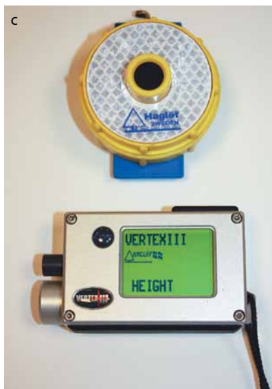
Współczesne wysokościomierze: a) mechaniczny; b) optyczny; c) ultradźwiękowy; d) laserowy
