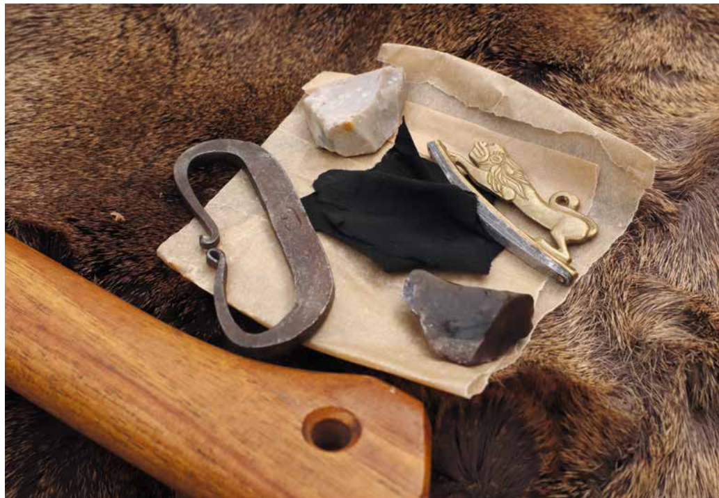
KRZESIWA pierwotne, kawałki stali węglowej do krzesania isker z krzemienia.
